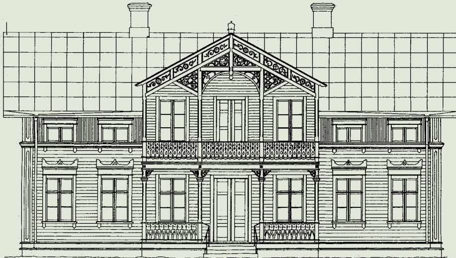
Tvåvånings salsbyggnad i liggtimmer med slätknut. Fasaderna är klädda med stående och liggande spontad panel.
